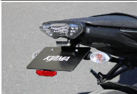
車輻イメージをさらに際立たせるフェンダーレスキット。ノーマルよりリア周りをスッキリさせて車輻全体の軽快感とコンパクトさをアピール。LEDのナンバー灯 /スリムリフレクター付き、純正ウインカー対応。
